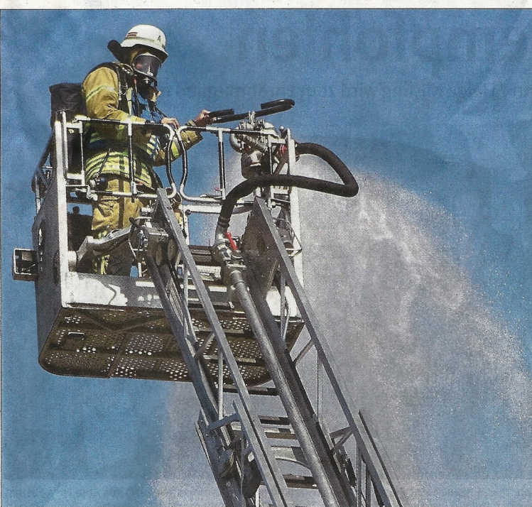
Die Mutlanger Drehleiter macht eine effektive Brandbekämpfung von oben möglich.
